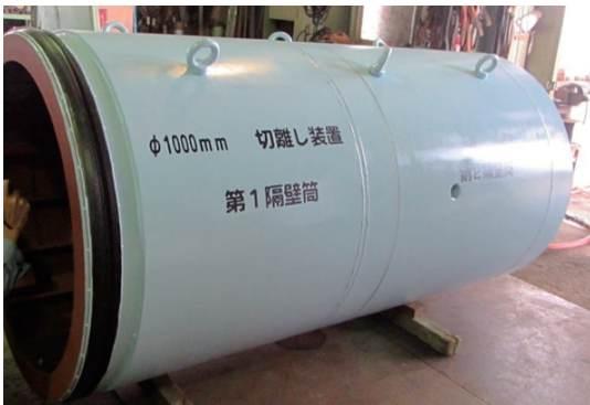
写真-3 切離し設備筒
