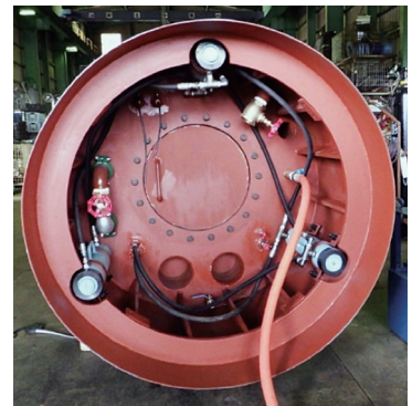
写真-5 切離し設備筒（推進管側）
