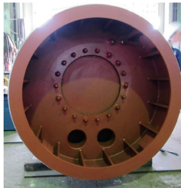
写真-4 切離し設備筒（掘進機側）
