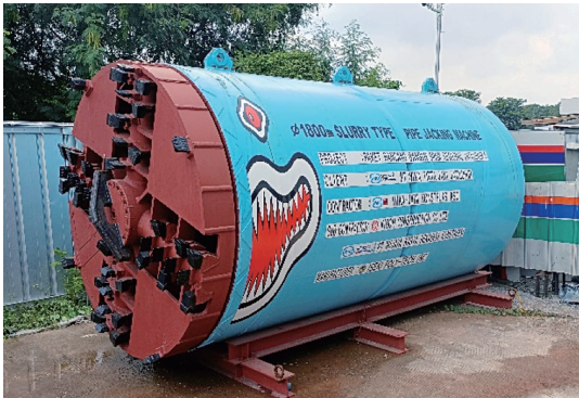
写真-6 呼び径1800泥水式掘進機
